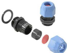
Prensaestopas de poliamida aptos para su uso en zonas con peligro de explosión Ex e (seguridad aumentada) y Ex i (seguridad intrínseca). Weidmüller ofrece una familia de productos sin restricciones y, además del cumplimiento de las normas, el prensaestopas destaca por su mayor resistencia al impacto de 4/7 julios y un rango de temperaturas admisible de hasta -60°C sin restricciones. Han sido probados conforme a la norma vigente y a la directiva EN 60079-0, disponen de certificación ATEX e IECEx.
