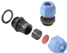
Prensaestopas de poliamida aptos para su uso en zonas con peligro de explosión Ex e (seguridad aumentada) y Ex i (seguridad intrínseca). Weidmüller ofrece una familia de productos sin restricciones y, además del cumplimiento de las normas, el prensaestopas destaca por su mayor resistencia al impacto de 4/7 julios y un rango de temperaturas admisible de hasta -60°C sin restricciones. Han sido probados conforme a la norma vigente y a la directiva EN 60079-0, disponen de certificación ATEX e IECEx.
