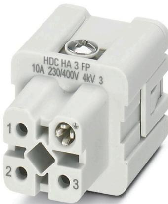
La tecnología de conexión push-in es una tecnología enchufable directa. El conductor pretratado puede ser insertado directamente en el nivel de conexión del conductor sin ayudas adicionales.
