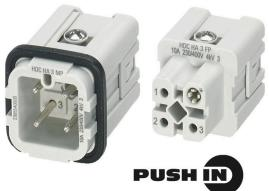
La tecnología de conexión push-in es una tecnología enchufable directa. El conductor pretratado puede ser insertado directamente en el nivel de conexión del conductor sin ayudas adicionales.
