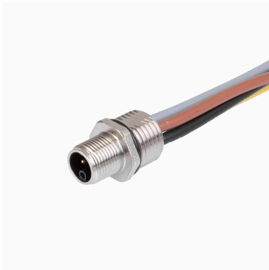
Sus dispositivos periféricos necesitan una fuente de alimentación de calidad. Con nuestro nuevo conector macho M12, podrá suministrar sin problemas más 250 V y 2 A. Los conectores macho M12 de tipo A-, K-, L-, S y T han sido diseñados para la transmisión de hasta 630 VCA o 60 VCC y 12 A.
