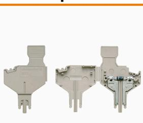
El enchufe para elementos de construcción se utiliza para integrar un componente eléctrico en un bloque de bornes seccionables. Después de soldar el componente electrónico, el conector macho se puede integrar en el área de desconexión de nuestros bloques de bornes seccionables y así cambia la regleta de bornes seccionables en una regleta de bornes modular con componente electrónico integrado.
