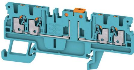
En algunas aplicaciones tiene sentido añadir una toma de prueba o un separador al borne con fines de prueba y seguridad. Los bornes seccionables de medición te permiten medir los circuitos eléctricos libres de tensión. Si bien la distancia de separación y de fuga de los puntos de desconexión no se evalúan en términos dimensionales, debe probarse la sobretensión de choque nominal especificada.
