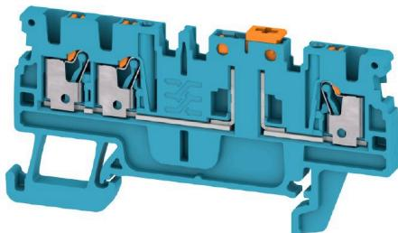
En algunas aplicaciones tiene sentido añadir una toma de prueba o un separador al borne con fines de prueba y seguridad. Los bornes seccionables de medición te permiten medir los circuitos eléctricos libres de tensión. Si bien la distancia de separación y de fuga de los puntos de desconexión no se evalúan en términos dimensionales, debe probarse la sobretensión de choque nominal especificada.
