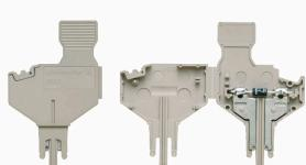
El enchufe para elementos de construcción se utiliza para integrar un componente eléctrico en un bloque de bornes seccionables. Después de soldar el componente electrónico, el conector macho se puede integrar en el área de desconexión de nuestros bloques de bornes seccionables y así cambia la regleta de bornes seccionables en una regleta de bornes modular con componente electrónico integrado.
