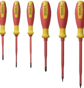
Destornillador con aislamiento VDE para uso en elementos bajo tensión de hasta 1000 V AC y 1500 V DC, DIN EN 60900, IEC 900. Seguridad verificada "GS", comprobación individual. Caña de aleación de acero, cromo, vanadio y molibdeno, endurecida y pavonada.
