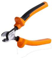
Herramientas para cortar cables de hasta 8 mm, 12 mm, 14 mm y 22 mm de diámetro exterior. La geometría especial de la cuchilla permite un corte sin estrangulamiento de conductores de cobre y aluminio, con esfuerzo físico mínimo. Las herramientas para cortar (KT 8 to KT 22) incluyen además aislamiento de protección sometido a pruebas VDE y GS de hasta 1.000 V de conformidad con la normativa EN/IEC 60900.
