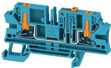
En algunas aplicaciones tiene sentido añadir una toma de prueba o un separador al borne con fines de prueba y seguridad. Los bornes seccionables de medición te permiten medir los circuitos eléctricos libres de tensión. Si bien la distancia de separación y de fuga de los puntos de desconexión no se evalúan en términos dimensionales, debe probarse la sobretensión de choque nominal especificada.
