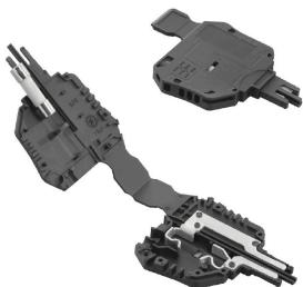
El soporte de fusible SIHA convierte rápidamente un borne seccionable en un borne portafusibles: sólo es necesario retirar la palanca de desconexión e insertar el enchufe con fusible.
