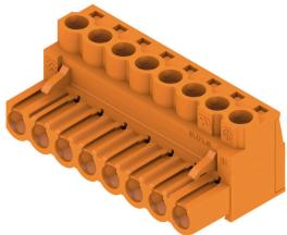
Conecotor hembra con conexión brida-tornillo para conexión de conductores con dirección de salida recta (180°). Los conectores hembra ofrecen espacio para la señalización y se pueden codificar. Sujetado mediante sujeción lateral o pasador de desbloqueo. Disponen también de un tornillo +/- integrado, protección contra inserción incorrecta del cable y se suministran con las bridas de embornado abiertas. HC = Alta intensidad
