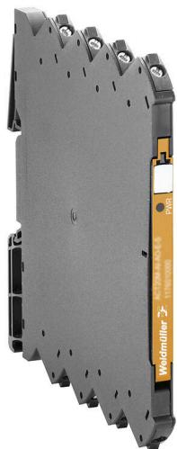
El convertidor de medida de frecuencia universal configurable por software separa y convierte las señales de entrada (frecuencia, Namur, NPN, PNP, tacómetro, TTL y SO) en una señal de salida estándar analógica activa. La alimentación eléctrica está separada galvánicamente de la entrada y la salida (separación de 3 vías) y se realiza mediante cableado directo. El modelo ACT20M-FRQ-AO-S puede alimentarse a través del carril DIN de Weidmüller
