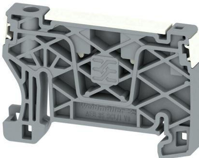
Para garantizar un asiento seguro y duradero sobre el carril y para evitar el deslizamiento, Weidmüller dispone de los ángulos de fijación. Se dispone de diseños con o sin tornillo. Existe la posibilidad de colocar sobre el ángulo de fijación señalizadores, incluso señalizadores de conjunto y la posibilidad de alojar una conector de prueba.
