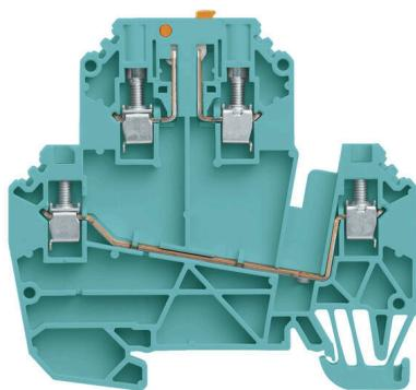
En algunas aplicaciones tiene sentido añadir una toma de prueba o un separador al borne con fines de prueba y seguridad. Los bornes seccionables de medición te permiten medir los circuitos eléctricos libres de tensión. Si bien la distancia de separación y de fuga de los puntos de desconexión no se evalúan en términos dimensionales, debe probarse la sobretensión de choque nominal especificada.
