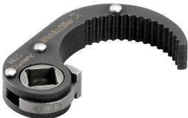
El accesorio Screwy® es compatible con los conectores redondos M23 personalizables y con los conectores redondos M23 sobremoldeados, con una dimensión exterior de la tuerca estriada de  $26,2 \pm 0,3$  mm. El par de apriete es de 2-2,5 Nm.
