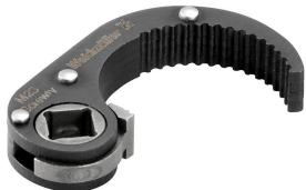
El accesorio Screwty® es compatible con los conectores redondos M23 personalizables y con los conectores redondos M23 sobremoldeados, con una dimensión exterior de la tuerca estriada de 26,2 ±0,3 mm. El par de apriete es de 2-2,5 Nm.
