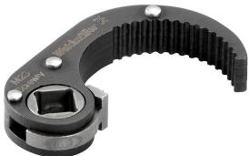
El accesorio Screwty® es compatible con los conectores redondos M23 personalizables y con los conectores redondos M23 sobremoldeados, con una dimensión exterior de la tuerca estriada de 26,2 ±0,3 mm. El par de apriete es de 2-2,5 Nm.
