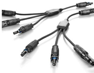
El cable en Y se utiliza para la conexión en paralelo de varias strings en un sistema fotovoltaico, por ejemplo, para dividir una línea antes de un inversor. Los cables están disponibles en diferentes variantes de conexión.
