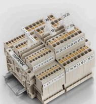
**SnapMark** - Este portaetiquetas está especialmente desarrollado para el borne de doble piso IDK 1.5N de la serie I. Gracias al mecanismo de rotación se pueden montar o sacar las conexiones transversales sin esfuerzo. En este sistema es posible disponer en cuatro señalizadores DEK 5 o dos señalizadores para conectores WS 10/5 Middle.
