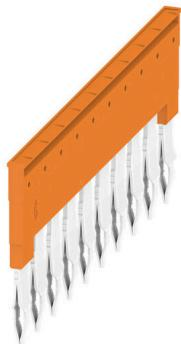
La distribución o multiplicación de un potencial a bornes contiguos se realiza a través de una conexión transversal. El esfuerzo adicional de cableado se puede evitar fácilmente. Incluso si los polos se rompen, la fiabilidad de contacto en los bornes sigue garantizada. Nuestro portafolio ofrece sistemas de conexión transversal enchufables y atornillables para bornes modulares.
