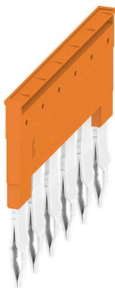
La distribución o multiplicación de un potencial a bornes contiguos se realiza a través de una conexión transversal. El esfuerzo adicional de cableado se puede evitar fácilmente. Incluso si los polos se rompen, la fiabilidad de contacto en los bornes sigue garantizada. Nuestro portafolio ofrece sistemas de conexión transversal enchufables y atornillables para bornes modulares.
