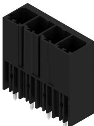
Conejero macho de alto rendimiento, de una hilera, para montaje en serie sin pérdida de polos o con sujeción patentada para enclavamiento rápido sin herramientas. La mejor fiabilidad de maniobra y funcionamiento gracias a una cara enchufable que impide errores de conexión, con diversidad de codificación única y sujeción adicional. La longitud del pin de 3,5 mm está optimizada para soldadura por ola sin plomo.
