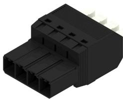
Conector macho invertido 180°, con conexión PUSH IN y actuador ajustable (pulsador), para conductores de 6 mm<sup>2</sup> en un paso de 7,62. También ideal como solución de protección frente al contacto con los dedos para tensiones inversas. Cumple los requerimientos de las normas UL 1059 600 V, clase C, e IEC 61800-5-1. Variantes: sin sujeción lateral, sujeción externa, sujeción intermedia enclavable y opcionalmente sujeción adicional por tornillo.
