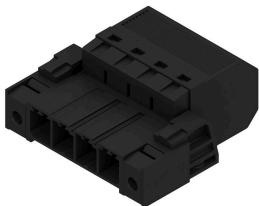
Conector macho invertido de 180°, con conexión PUSH IN, para cableado de campo, de hasta 6 mm<sup>2</sup>, con paso de 7,62, como "variante de tres sujetaciones" para pasamuros en cajas. Indicado para cajas con un grosor de pared máx. de 2 mm. También es ideal como solución de protección frente a contacto con los dedos para tensiones inversas. Cumple los requerimientos de las normas UL1059 600 V Class C e IEC 61800-5-1.
