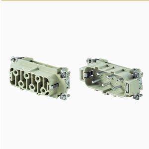
La serie HSB permite obtener 35 A simultáneamente en cada contacto. El montaje se realiza con una conexión brida-tornillo garantizando una conexión segura y fiable. El nivel de conexión de conductores está realizado con elementos roscados. Todos los elementos de conexión brida-tornillo están equipados con un muelle protector de alambre.
