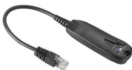
Módulo de para guardar y cargar la configuración de un dispositivo
