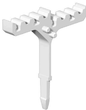
SnapMark - Este portaetiquetas está especialmente desarrollado para el borne de doble piso IDK 1.5N de la serie I. Gracias al mecanismo de rotación se pueden montar o sacar las conexiones transversales sin esfuerzo. En este sistema es posible disponer en cuatro señalizadores DEK 5 o dos señalizadores para conectores WS 10/5 Middle.
