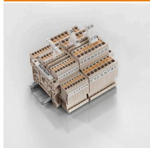
SnapMark - Este portaetiquetas está especialmente desarrollado para el borne de doble piso IDK 1.5N de la serie I. Gracias al mecanismo de rotación se pueden montar o sacar las conexiones transversales sin esfuerzo. En este sistema es posible disponer en cuatro señalizadores DEK 5 o dos señalizadores para conectores WS 10/5 Middle.
