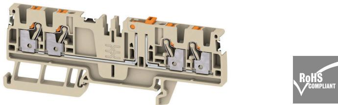
En algunas aplicaciones tiene sentido añadir una toma de prueba o un separador al borne con fines de prueba y seguridad. Los bornes seccionables de medición te permiten medir los circuitos eléctricos libres de tensión. Si bien la distancia de separación y de fuga de los puntos de desconexión no se evalúan en términos dimensionales, debe probarse la sobretensión de choque nominal especificada.
