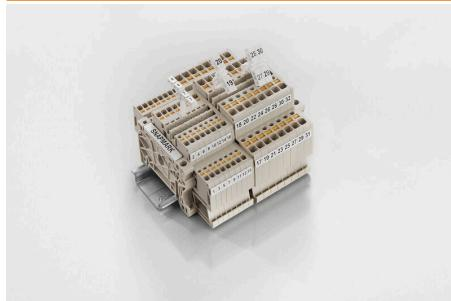
SnapMark - Este portaetiquetas está especialmente desarrollado para el borne de doble piso IDK 1.5N de la serie I. Gracias al mecanismo de rotación se pueden montar o sacar las conexiones transversales sin esfuerzo. En este sistema es posible disponer en cuatro señalizadores DEK 5 o dos señalizadores para conectores WS 10/5 Middle.
