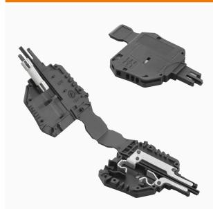
El soporte de fusible SIHA convierte rápidamente un borne seccionalable en un borne portafusibles: sólo es necesario retirar la palanca de desconexión e insertar el enchufe con fusible.
