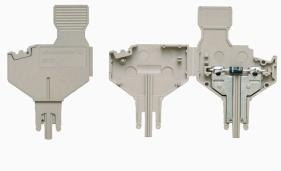
El enchufe para elementos de construcción se utiliza para integrar un componente eléctrico en un bloque de bornes seccionables. Después de soldar el componente electrónico, el conector macho se puede integrar en el área de desconexión de nuestros bloques de bornes seccionables y así cambia la regleta de bornes seccionables en una regleta de bornes modular con componente electrónico integrado.
