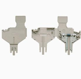
El enchufe para elementos de construcción se utiliza para integrar un componente eléctrico en un bloque de bornes seccionables. Después de soldar el componente electrónico, el conector macho se puede integrar en el área de desconexión de nuestros bloques de bornes seccionables y así cambia la regleta de bornes seccionables en una regleta de bornes modular con componente electrónico integrado.
