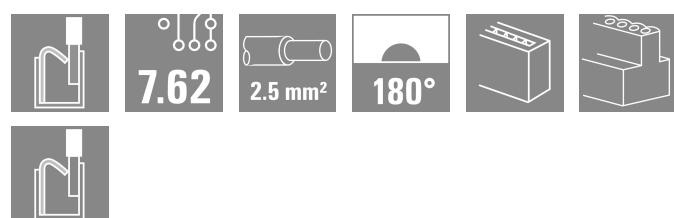
Conecotor macho invertido de 180° con conexión PUSH IN para cables de hasta 2,5 mm<sup>2</sup> con un paso de 7,62. También ideal como solución con protección frente al contacto con los dedos para tensiones inversas.
