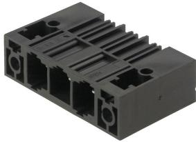
Conector macho para alta intensidad, de una hilera, para montaje en serie sin pérdida de polos o con sujeción patentada para enclavamiento rápido sin herramientas. La mejor fiabilidad de maniobra y funcionamiento gracias a una cara enchufable que impide errores de conexión, con diversidad de codificación única y sujeción adicional. La longitud del pin de 3,5 mm está optimizada para soldadura por ola, con dirección de montaje de 90° a los pines de soldadura.
