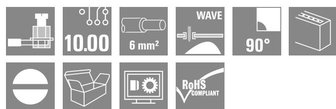
Borne para placas de circuitos impresos con conexión brida-tornillo garantizada en pasos de 10 y 10,16 mm, con dirección de salida del conductor de 90°. Idóneo para secciones de conductor de hasta 6,0 mm<sup>2</sup>.
