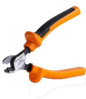
Herramientas para cortar cables de hasta 8 mm, 12 mm, 14 mm y 22 mm de diámetro exterior. La geometría especial de la cuchilla permite un corte sin estrangulamiento de conductores de cobre y aluminio, con esfuerzo físico mínimo. Las herramientas para cortar (KT 8 to KT 22) incluyen además aislamiento de protección sometido a pruebas VDE y GS de hasta 1.000 V de conformidad con la normativa EN/IEC 60900.
