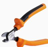
Herramientas para cortar cables de hasta 8 mm, 12 mm, 14 mm y 22 mm de diámetro exterior. La geometría especial de la cuchilla permite un corte sin estrangulamiento de conductores de cobre y aluminio, con esfuerzo físico mínimo. Las herramientas para cortar (KT 8 to KT 22) incluyen además aislamiento de protección sometido a pruebas VDE y GS de hasta 1.000 V de conformidad con la normativa EN/IEC 60900.
