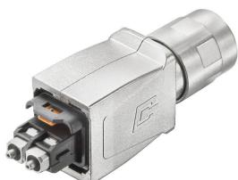
Conejero PushPull según IEC 61076-3-117 Var.14 (PROFINET) de metal incl. conejero SC
