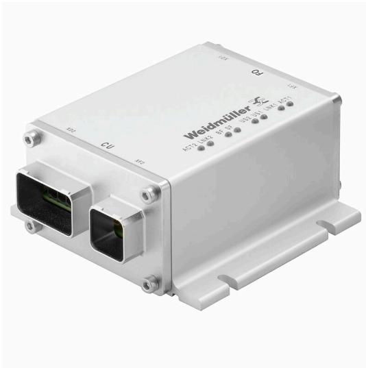
Convertidor de cables FreeCon Active PROFINET con función de diagnóstico, para conector PushPull variante 14 según IEC 61076-3-117 con RJ45 y SC-RJ POF según IEC 61754-24 y PushPull Power según la especificación PROFINET.
