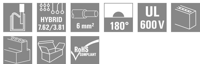
Conector hembra de 180° con contactos de alimentación y datos, conexión de conductor PUSH IN y paso de 7,62. Cumple los requisitos de la norma IEC 61800-5-1 y la norma UL 1059 ClassC 600 V para el contacto de alimentación. Con impulsor ajustable y autoportante para la apertura del punto de contacto.
