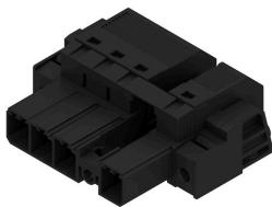
Conejero macho invertido de 180° con conexión PUSH IN para cables de hasta 6 mm<sup>2</sup>, con un paso de 7,62, y tres puntos de fijación. Apto para carcasa con grosor de pared máx. de 16 mm.
