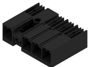
Conecotor macho de 90° con sujeción intermedia, de 7,62 de paso. Cumple los requerimientos de IEC 61800-5-1 y admite homologación UL conforme a UL840 600 V. Sin un conector hembra, la cara enchufable garantiza una protección frente al contacto con los dedos mínima de >3 mm con 20 N de presión en el ensayo.
