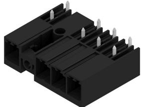
Conecotor macho de 270° con sujeción intermedia de 7,62 de paso. Cumple los requerimientos de la norma IEC 61800-5-1 y admite homologación UL conforme a UL840 600 V. Sin un conector hembra, la cara enchufable garantiza una protección frente al contacto con los dedos mínima de >3 mm con 20 N de presión en el ensayo.
