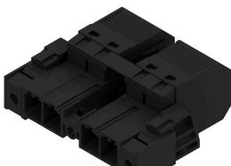
Conejero macho invertido de 180° con conexión PUSH IN para cables de hasta 6 mm<sup>2</sup>, con un paso de 7,62, y tres puntos de fijación. Apto para carcasa con grosor de pared máx. de 2 mm.
