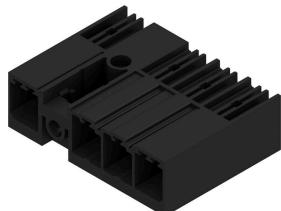
Conector macho de 90° con sujeción intermedia, de 7,62 de paso. Cumple los requerimientos de IEC 61800-5-1 y admite homologación UL conforme a UL840 600 V. Sin un conector hembra, la cara enchufable garantiza una protección frente al contacto con los dedos mínima de >3 mm con 20 N de presión en el ensayo.
