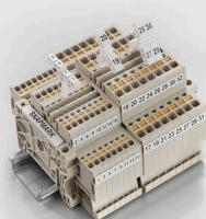
**SnapMark** - Este portaetiquetas está especialmente desarrollado para el borne de doble piso IDK 1.5N de la serie I. Gracias al mecanismo de rotación se pueden montar o sacar las conexiones transversales sin esfuerzo. En este sistema es posible disponer en cuatro señalizadores DEK 5 o dos señalizadores para conectores WS 10/5 Middle.
