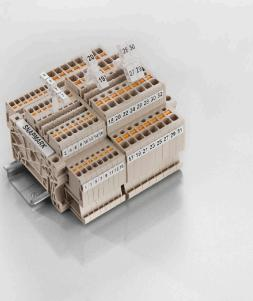
**SnapMark** - Este portaetiquetas está especialmente desarrollado para el borne de doble piso IDK 1.5N de la serie I. Gracias al mecanismo de rotación se pueden montar o sacar las conexiones transversales sin esfuerzo. En este sistema es posible disponer en cuatro señalizadores DEK 5 o dos señalizadores para conectores WS 10/5 Middle.
