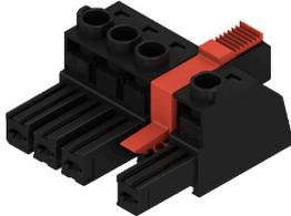
Conector hembra de 180° con un paso de 7,62 para redes TI. Cumple los requisitos de la norma UL1059 600 V, clase C. En combinación con el conector macho SV 7.62 IT.. con contacto en avance.
