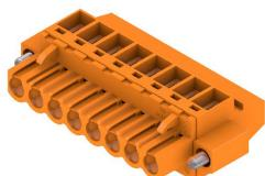
Conecotores hembra con conexión brida-tornillo para conexión de conductores con dirección de salida recta (90° o 270°). Los conectores hembra ofrecen espacio para la señalización y se pueden codificar. Sujetado mediante sujeción lateral o pasador de desbloqueo. Disponen también de un tornillo positivo/negativo integrado, protección contra inserción incorrecta del cable y se suministran con bridgas-tornillo abiertas. HC = Alta intensidad
